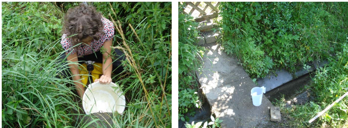
Abbildung 11: Messung der Abflussmenge mittels Eimer (links) und mittels Salzverdünnungsverfahren (rechts)
