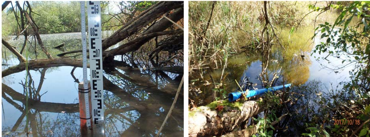
Abbildung 13: Messung des Wasserspiegels im Riedsee mit Pegellatte (links) und Datenlogger (rechts, in blauem Schutzrohr)
