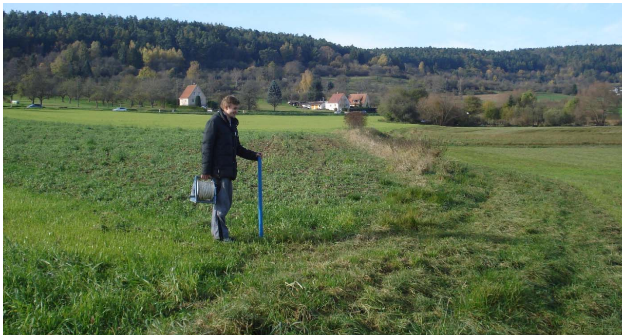
Abbildung 10: Messung des Grundwasserspiegels im Umfeld von Quelle 3 (Plangebiet „Unter dem Weiler Weg“ mittels temporärer Grundwasserpeilrohre
